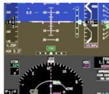
PinS Anflüge stellen sich auf der onboard Avionik weitestgehend analog zu ILS Anflügen dar und erfordern somit crewseitig keinen signifikanten Trainingsaufwand.
